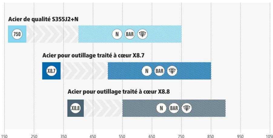
La dureté de base est déterminante pour la résistance aux chocs et une durée de vie très longue de la table de soudure. La nituration plasma puis le revêtement BAR rendent la surface très dure. Ce qui permet une protection contre les rayures, la corrosion et les projections de soudure. La combinaison de la dureté de base avec la nituration plasma sont nécessaires pour obtenir une surface sans déformation et durable dans le temps.
