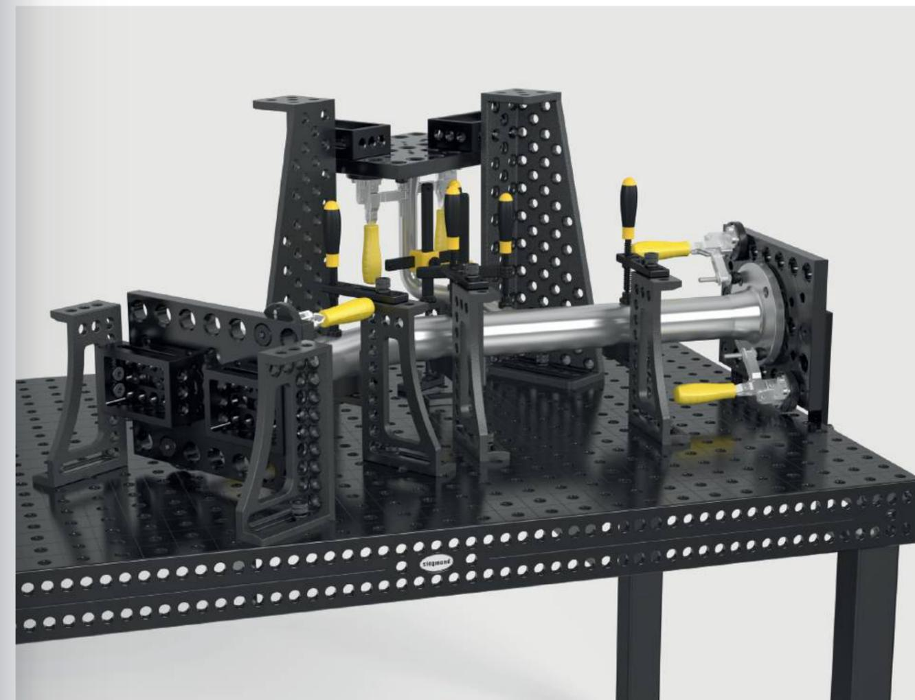
**Plaque de bridage 550 pour bride DIN avec boulons de fixation nitrurée**
