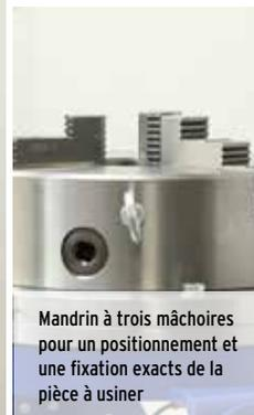
Mandrin à trois mâchoires pour un positionnement et une fixation exacts de la pièce à usiner
