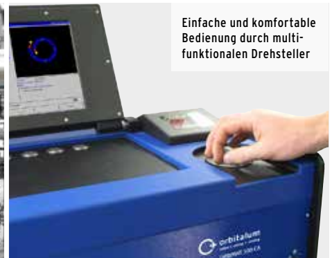
10,5"-Schwenkmonitor und Systemdrucker integriert
