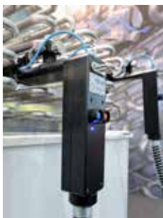
Alle Anschlüsse für Strom, Gas, Kühlwasser sind fest integriert
