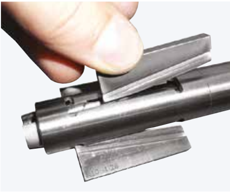
Le système de serrage « NC » est imperdable grâce à ses cales de serrage solidement ancrées dans le mandrin
