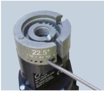
Elektroden anschleifen: 4 unterschiedliche Winkel, 6 unterschiedliche Elektrodendurchmesser
