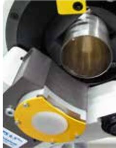
Bewährtes Planetenschneidprinzip: Das Sägeblatt taucht in den Schnitt ein und wird orbital um das Rohr herum geführt
