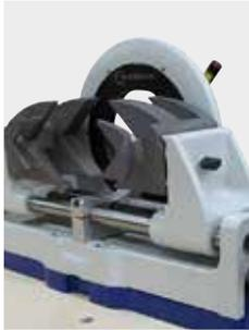
Selbstzentrierender Spannstock aus hochwertiger Aluminium-Legierung
