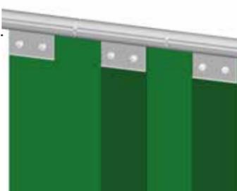
6 Bei einer Überlappung von 5 cm (33%) lassen Sie bitte jeweils 1 Loch frei und setzen Sie zur Ausfüllung ein Distanzstücke ein.
