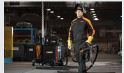
Das leichte Zwischenvorschubgerät ist eine ergonomische Alternative zu schweren und großen Drahtvorschubgeräten oder das Schweißen mit schweren Push/Pull-Schweißbrennern, die das Handgelenk des Schweißers stärker belasten.
