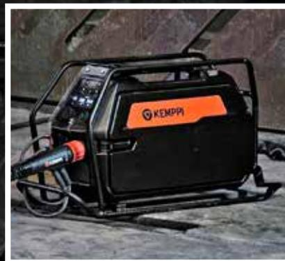
Der optionale Metallschutzrahmen für den 200-mm-HD-Drahtvorschub sorgt für zusätzliche Haltbarkeit unter extremen Einsatzbedingungen.
