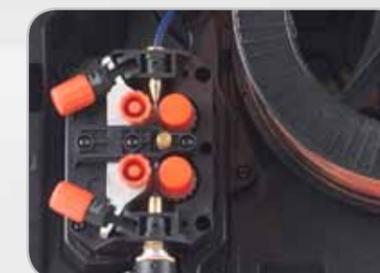
Les modèles Kempact 253/323 disposent d'un système de dévidage à 4 galets DuraTorque.
