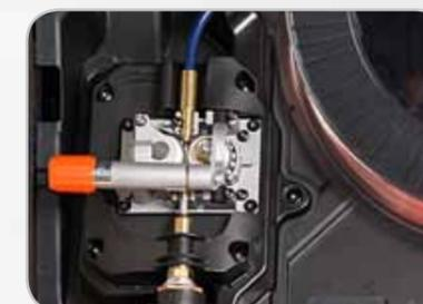
Les modèles Kempact 181/251 disposent d'un système de dévidage à 2 galets GT02.
