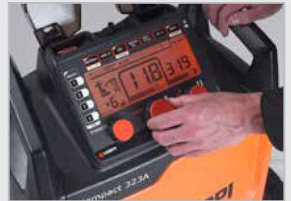
Die großen und gut ablesbaren LCD-Bedienpaneele vereinfachen die Einstellung der Parameter und Bezugswerte. Staufächer bieten praktische Lagerung und Zugang.
