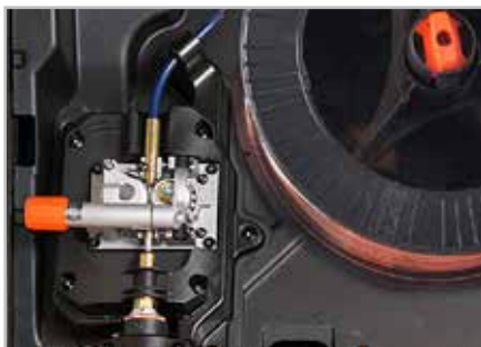
Die Kempact 251-Modelle verfügen über den GT02C-Drahtvorschub mit zwei Rollen.
