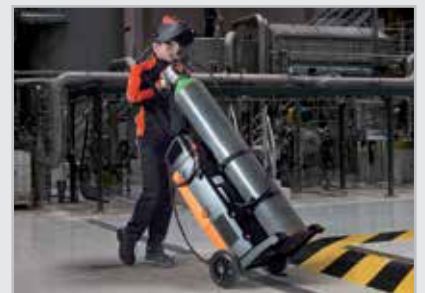
Das GasMate-Gehäusedesign erleichtert das Einsetzen und Aufbewahren der Gaszylinder sowie das Bewegen der Maschine. Die Gaszylinder werden auf Bodenebene eingesetzt und mit starken Gewebegurten gesichert.
