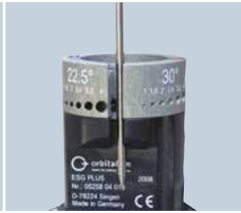
Coupure à longueur des électrodes
