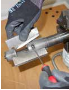
Réglage rapide de la dimension du tube
