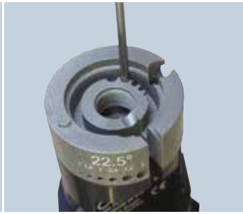
Dressage de la pointe d'électrode
