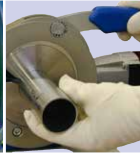
Système de changement rapide pour les outils, coquilles de serrage et tubes
