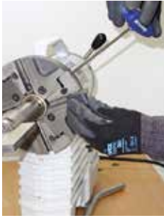
Système de serrage rapide des outils QTC® (Quick-Tool-Change)
