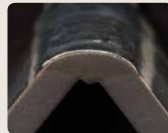
Un arc stable permet d'obtenir une soudure régulière et la fixation solide du matériau de base, conférant ainsi de bonnes propriétés mécaniques à la soudure.
