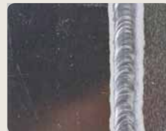
La fonction MIX TIG combine les avantages des courants continu et alternatif. Elle facilite le soudage de pièces en aluminium et réduit le nombre de déformations.
