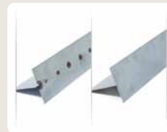
La différence est clairement visible sur les points de soudure. MicroTack a été utilisé pour souder la pièce tandis que le pointage sur la pièce de gauche a été réalisé en procédé TIG traditionnel.
